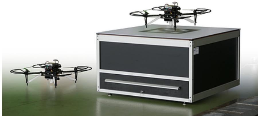
**Figura:** Drone Yacob da Dronematrix e o seu *docking station* [6]
